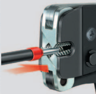
Ładowanie tulejki od czoła
