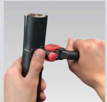
Cięcie po obwodzie
