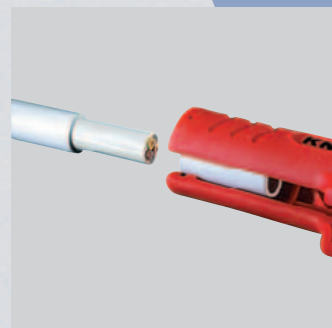
Ściąganie izolacji z kabli okrągłych o średnicy 8,0 - 13,0 mm
