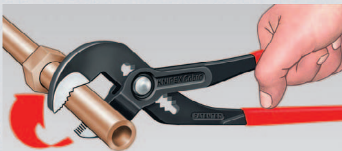
Samozaciskające się na rurach i nakrętkach, co zabezpiecza przed zsunieniem się z chwytanego przedmiotu. Wymagają użycia niewielkiej siły
