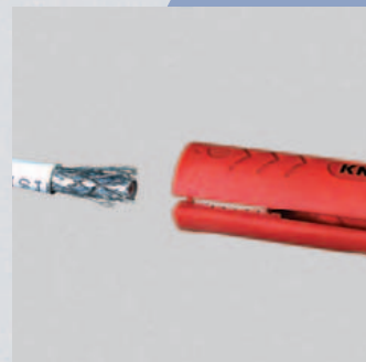
Usuwanie zewnętrznej izolacji z kabli koncentrycznych o średnicy 4,8-7,5 mm
