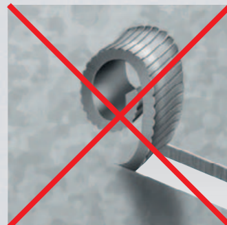
Wykrawanie bez łamania wiórów
