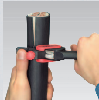
Obrócenie narzędzia do cięcia po obwodzie
