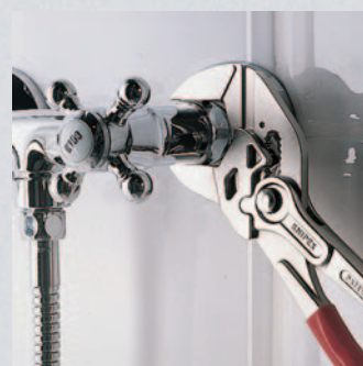
Umożliwiają montaż delikatnej armatury sanitarnej bez uszkodzenia powierzchni
