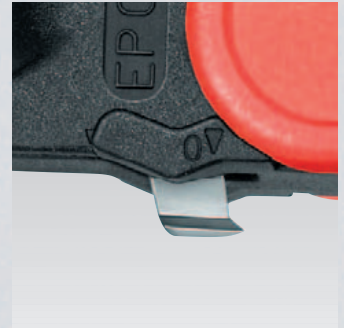
Regulowana głębokość cięcia
