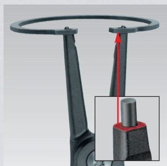
Pierścienie są pewnie chwywane: duża powierzchnia styku oraz pozycja końcówek zapobiega ześlizgnięciu się pierścienia podczas montażu
