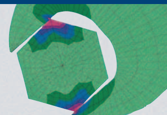
Tradycyjny klucz płaski: naprężenia na krawędziach mogą spowodować uszkodzenia
